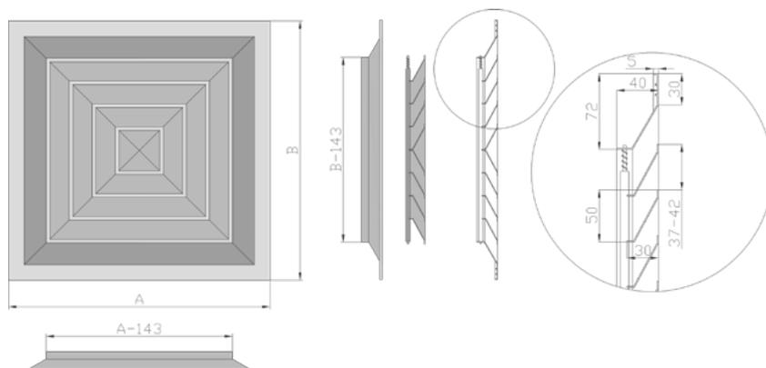
**Габаритно-посадочные размеры потолочной решетки с клапаном расхода воздуха R1**
