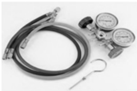
Рисунок 11: Сервисный манометрический коллектор и индикаторы давления
